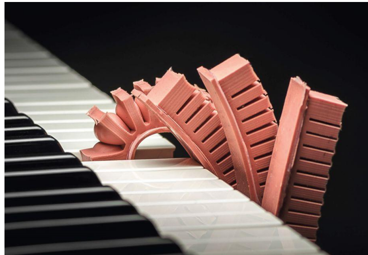
Pneu Net (Actuador blando Neumatico, Mosadegh, Polygerinos et al. 2014)
