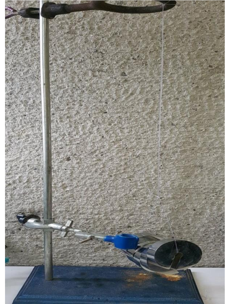
Prueba de carga y alargamiento del Músculo de Nylon
